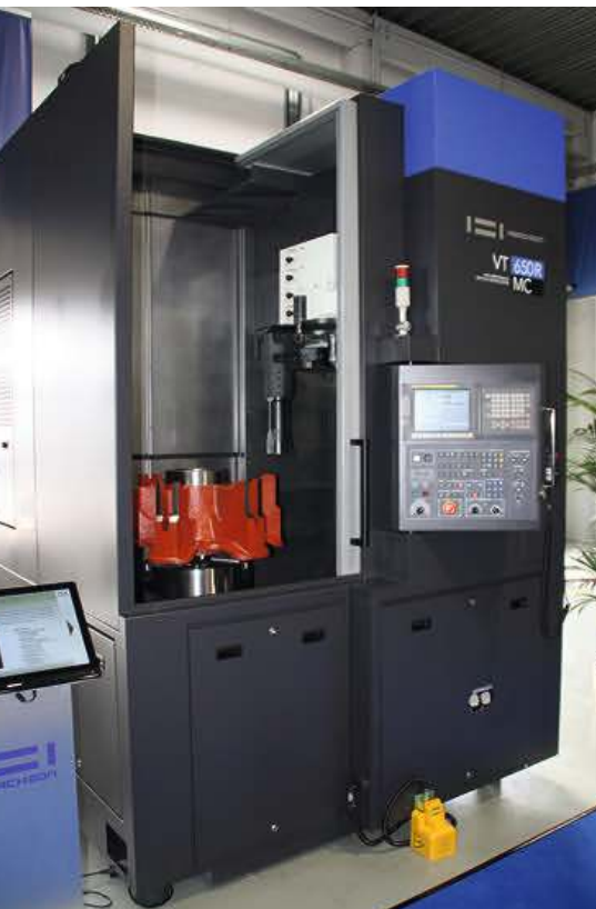
6 Vertikal-Drehmaschine VT 650R: besonders geeignet für sehr schwere Teile und schwer zerspanbare Materialien; erhältlich mit angetriebenen Werkzeugen
