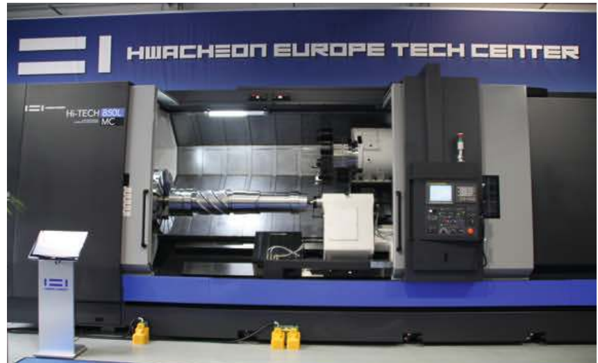
5 Erfolgsgarant Hi-Tech-Serie: Das im neuen Showroom ausstellte größte Modell 850L verfügt über ein stabiles Gussbett, Flachführungen und ein vierstufiges Automatikgetriebe; das Paket meistert Werkstücke bis 920 mm Durchmesser und 3,5 m Länge
