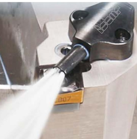
**1** Ausgerüstet mit zielgerichteter Kühlschmierstoff-Zufuhr: die Werkzeugreihe Jet HP Line von Iscar
