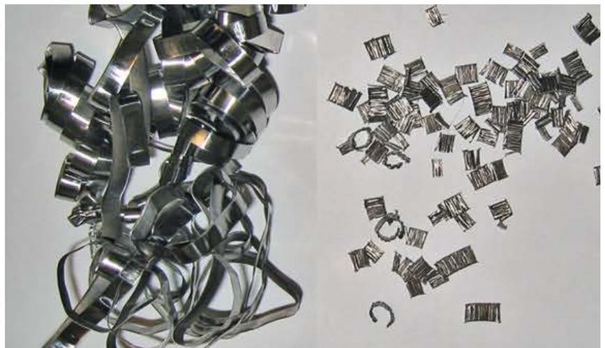
4 Beim Stechen mit zielgerichteter KSS-Zufuhr werden kurze Späne erzeugt (rechts), was den Prozess deutlich sicherer macht
