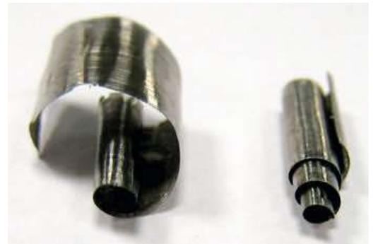
6 Auch beim Fräsen sorgt die zielgerichtete KSS-Zufuhr für eine höhere Prozesssicherheit – die Späne zeigen es
