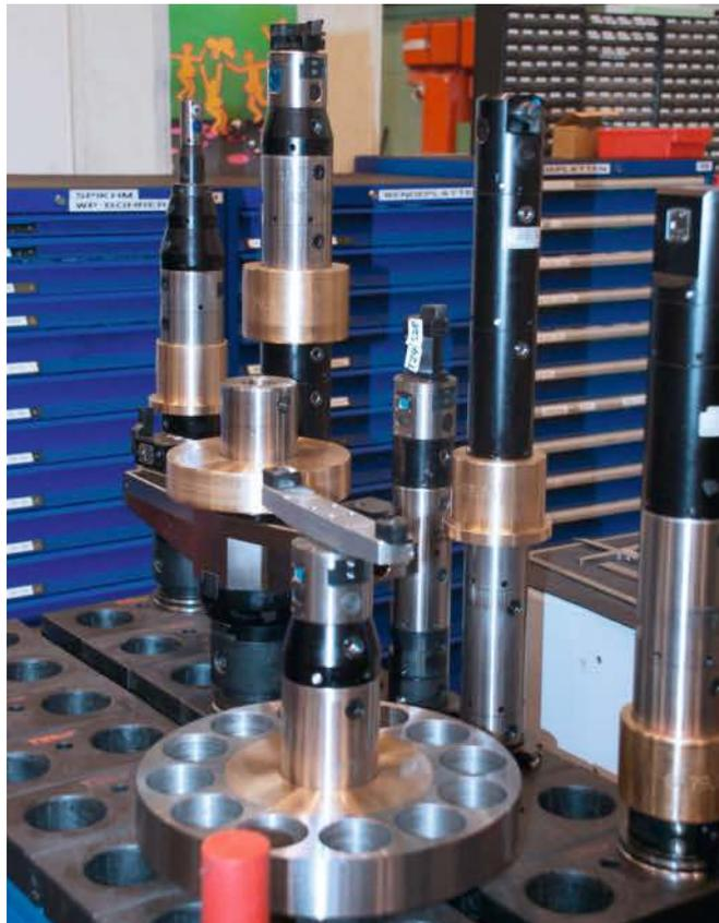
4 Die montierten MultiBore-Werkzeuge für die verschiedenen Bohrungen. Im unteren Teil sieht man die Bronzebuchsen, die bei DST im eigenen Hause gefertigt werden
