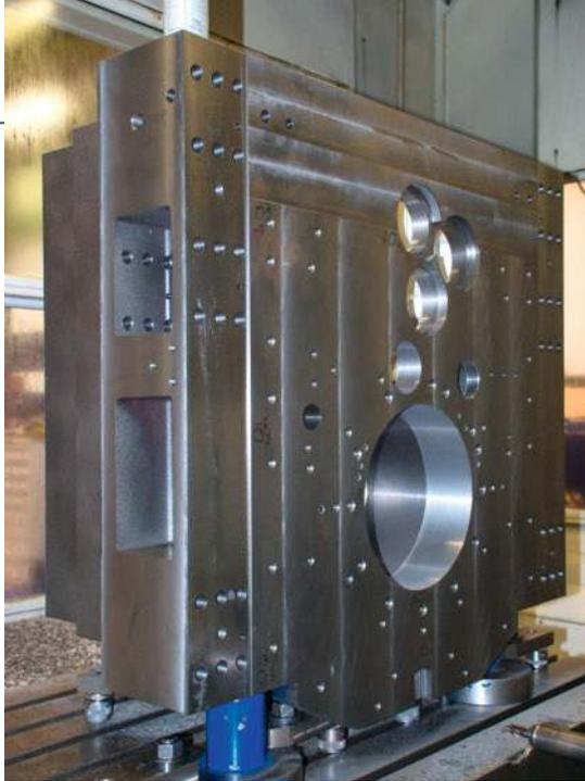
**2** Der zu bearbeitende Getriebekasten, aufgespannt auf einem 3-Achs-Bearbeitungszentrum EcoCut 1.3. Die zu bearbeitenden Bohrungen befinden sich in drei Ebenen
