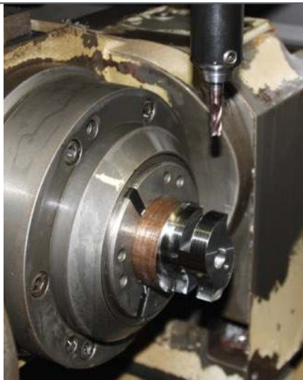
4 Komplettbearbeitung von der Stange: Schwanog fertigt mittlerweile sämtliche Grundkörper der kundenspezifischen Profilwerkzeug-Wechselsysteme in Eigenregie auf 5-Achs-Fräs- und Fräs-Dreh-Zentren von Stama
