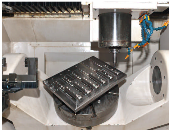
4 Multiplikator: aap praktiziert die Mehrfachaufspannung auf Wechselplatten. Prozessparallel bestückt, geht das Umrüsten schnell von der Hand
