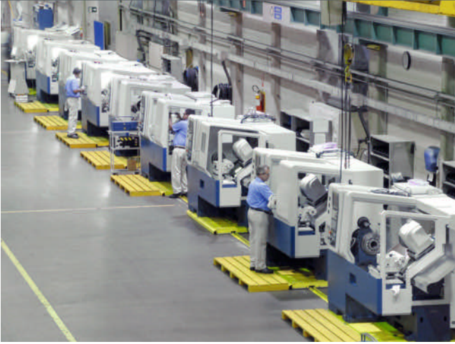
4 Takt-Montagelinie für Drehmaschinen: Romi setzt auf eine hohe Fertigungstiefe bei der Maschinenfertigung, inklusive Gießerei und Blechbearbeitung
