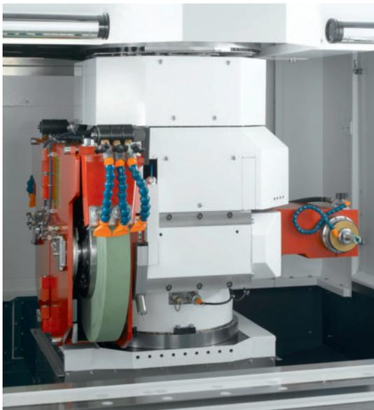
**3** Ansicht des Revolver-schleifspindelstocks: Angetrieben durch einen Direktantrieb, schwenkt der Revolver-Schleifspindelstock der S41 etwa dreimal schneller um die B-Achse und sorgt für eine Positionierstreuung kleiner 1" der jeweils neu zum Eingriff kommenden Schleifscheibenposition
