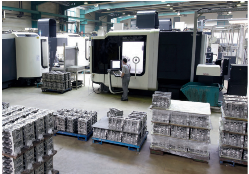
1 Bisher wurden vier neue DMC 75 H duoBlock für das Feinfräsen von ZSB-Zylinderkurbelgehäusen in die Wertschöpfungskette von Saarotec integriert
