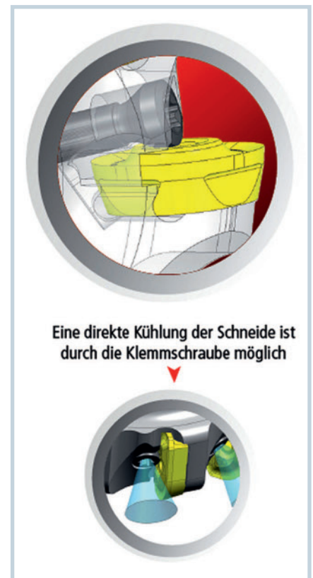
4 Das Schneidplattenklemmsystem Sidelok verzichtet auf ein Mittelloch mit Schraubenklemmung, ist somit stabiler und bietet bis zu doppelt so vielen Platten Sitz
