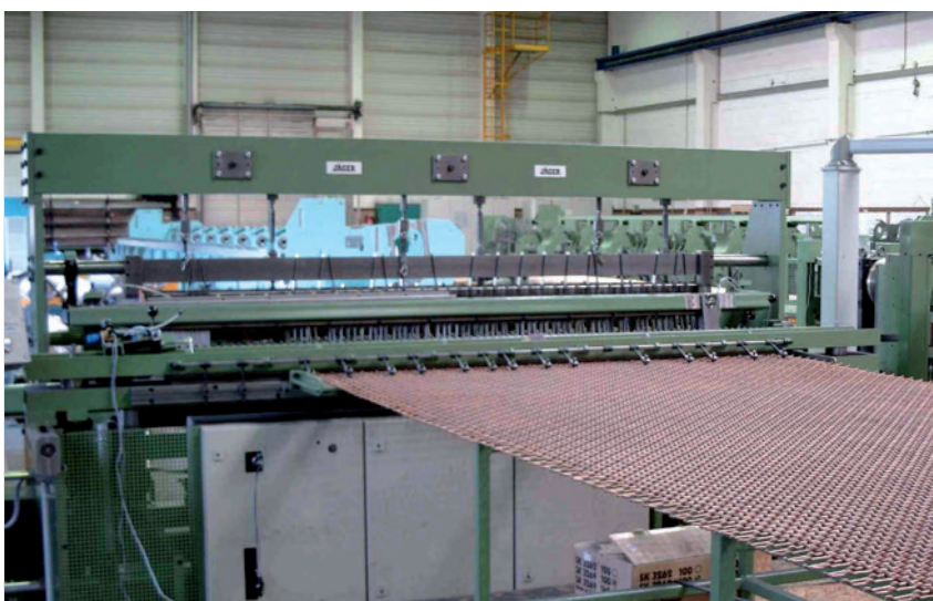
1 Ein wichtiges Segment von Schlatter sind Maschinen für Drahtgewebe und -gitter. Im Bild ist der Prozess des Gitterwebens festgehalten
