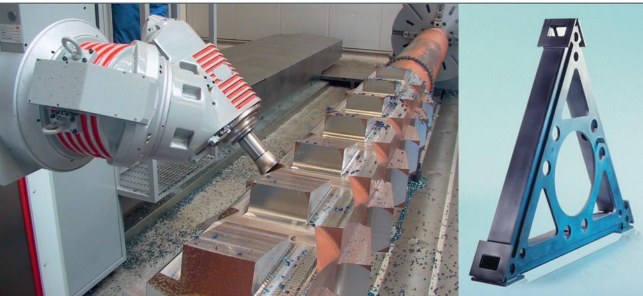
**1** Kernkompetenzen von Schmidt Zerspantungstechnik sind Lohnarbeiten in den Bereichen Fräsen, Drehen, Schleifen oder Bohren. Links die Bearbeitung einer Haspelwelle, rechts ein Schweißteil, das auch noch mechanisch bearbeitet wurde
