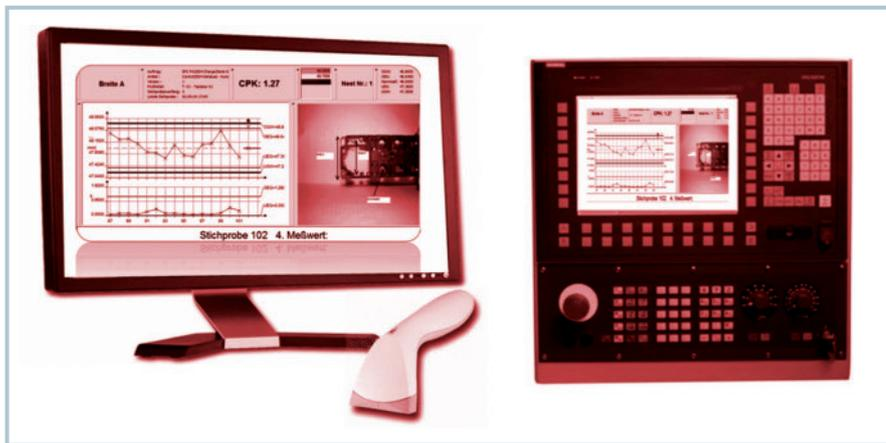
5 Offen für alles: Die Ermittlung von CPK- oder Statistikwerten kann auf der Steuerung (rechts) wie auf einem PC laufen
