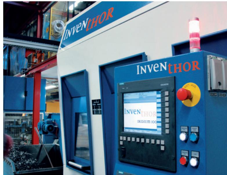
**3** Im Konzept liegt die Würze: Die Vertikal-Drehmaschine Inventhor Iridium 100 kann durch internes Handling hauptzeitparallel beladen
