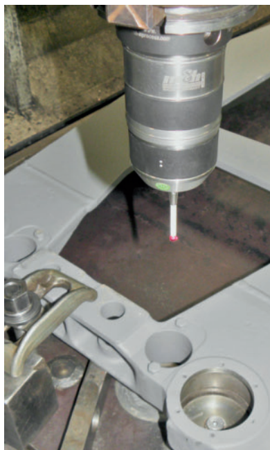
5 Für das Portal der Drehgestelle sind die Bearbeitung und das Messen der Führungsbuchsen auf der Werkzeugmaschine die Schlüsseloperationen
