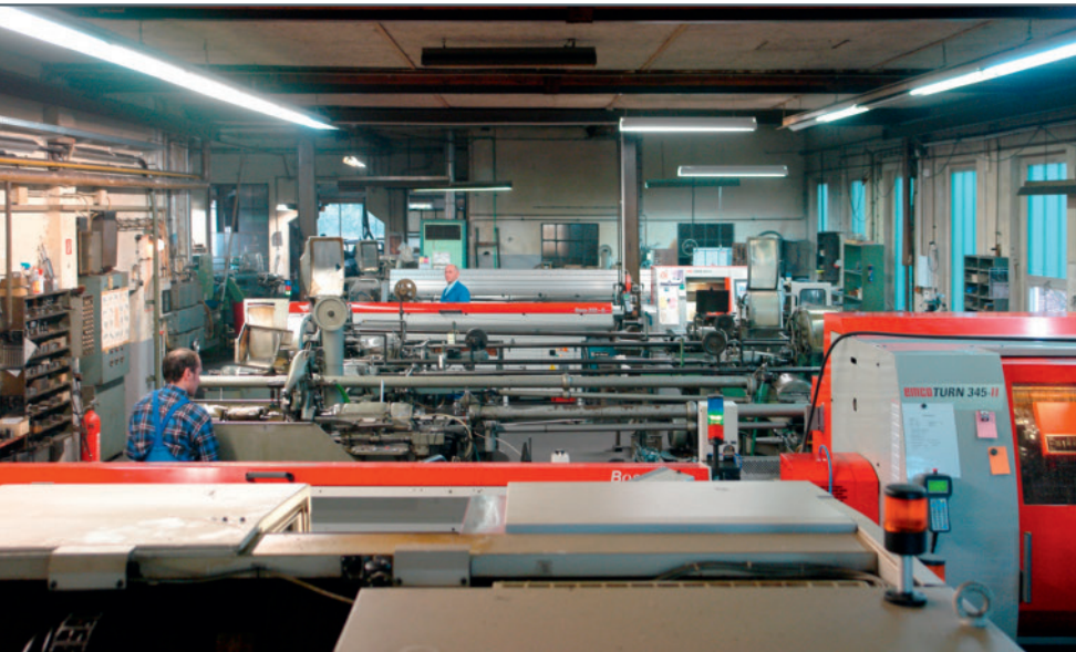
4 Angeschlossen werden kann die Werkzeugüberwachung an allen CNC-Maschinen. Vorn rechts im Bild das als erste mit dem ›Tool Monitor‹ ausgerüstete Emco-Drehzentrum
