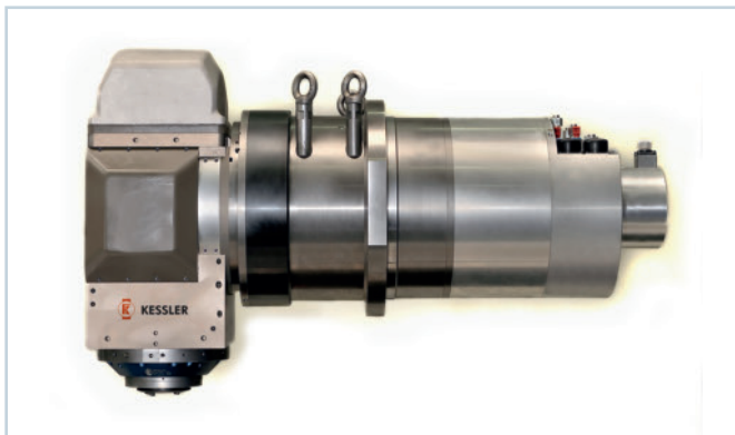
1 Kessler ›Orthogonal System‹: Schwenkeinheit für Fahrständermaschinen, Arbeitsmoment 1000 Nm, Feststellmoment 5000 Nm, Drehzahl 100 min -1 , Genauigkeit 2“, Spindel 25 kW/18 000 min -1 , HSK 63 und Hirthverzahnung
