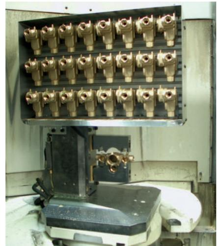
Das Handhabungssystem von NC-Automation hat gegenüber Roboterlösungen erhebliche Vorteile beim Raumbedarf, bei den Investitionskosten und der Zugänglichkeit zur Maschine
