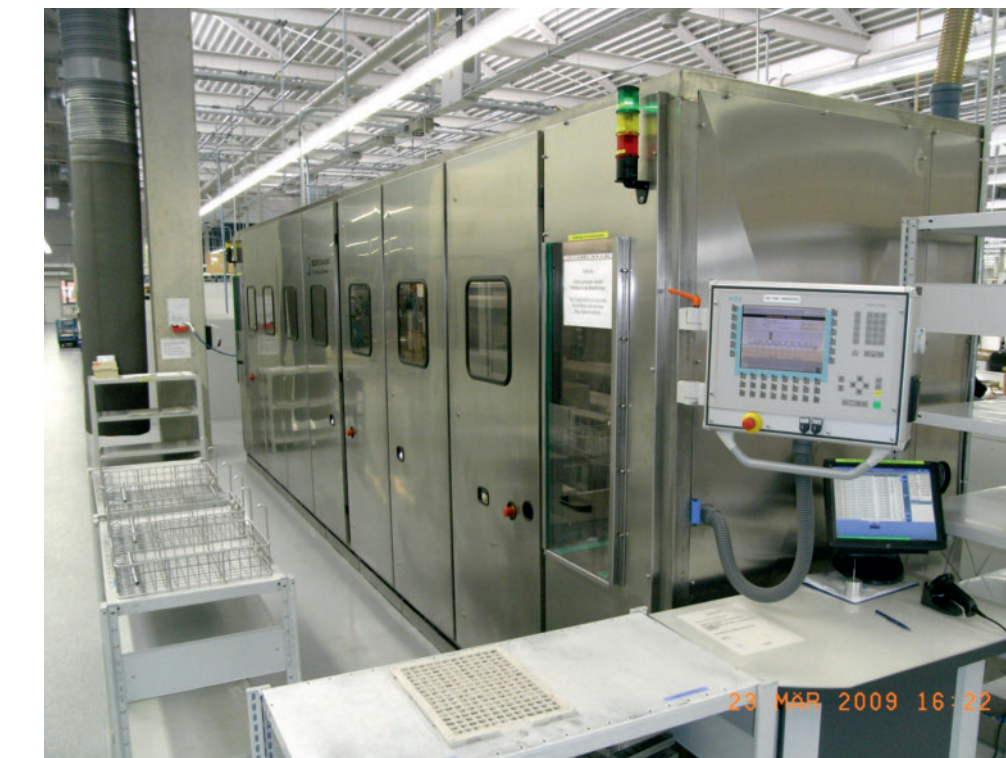
3 Reinigen mit Ultraschall: Die Wendeschneidplatten werden in drei Reinigungszyklen und drei Spülstufen gereinigt, das letzte Spülen erfolgt mit VE-Wasser
