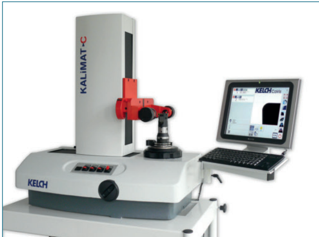
1 Manuelles Werkzeugeinstellgerät ›Kalimat C‹ mit der neuen, intuitiv am Touchscreen zu bedienenden Steuerung ›CoVis‹
