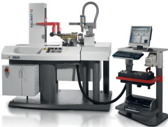
3 Rationalisiertes Einstellen und Inspizieren von Werkzeugen: automatisches Werkzeugsinstellgerät ›Kalimat AM/R‹, auf dem ein Handhabungsgerät die Demontage und Montage von Wendeschneidplatten übernimmt
