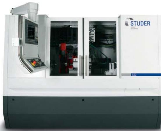
**4** Produktionsplattform ›S22‹ von Studer: Beliebige Konfigurierbarkeit mit bewährten Komponenten ermöglicht die Anpassung an nahezu unbegrenzte Rundschleifanwendungen
