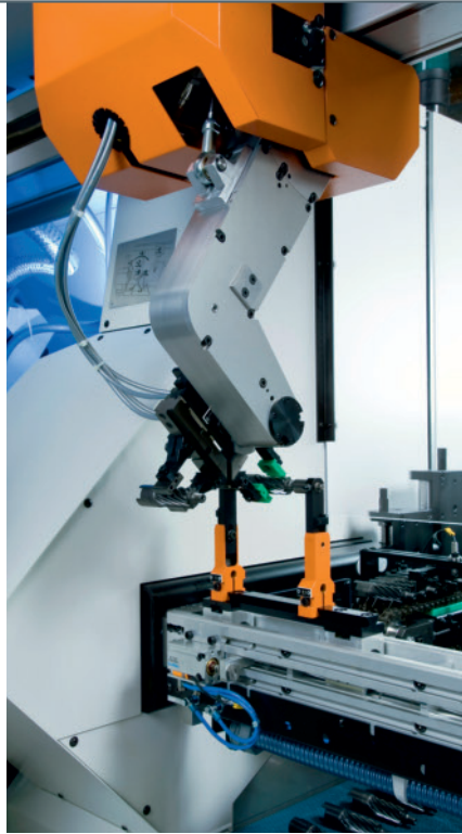
5 Das integrierte Ladeportal mit Doppel-Rotationsgreifer ermöglicht kürzeste Lade- und Entladezeiten. Rohling- und Fertigteilmagazine stehen für die verschiedensten Teilespektren und Autonomie-Anforderungen zur Verfügung
