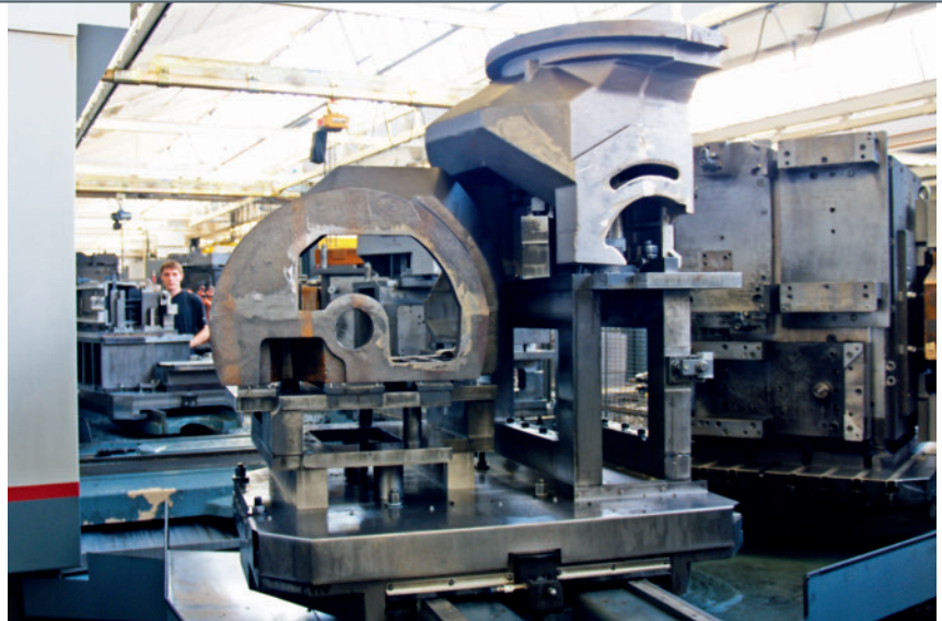
2 Die Fertigung in Mühlacker-Lomersheim zeichnet vor allem eine hohe Wertschöpfungstiefe aus. So zerspannt man beispielsweise 90 Prozent aller Gussteile selbst, zu denen auch der Schwenktisch einer Doppelgehrungssäge gehört
