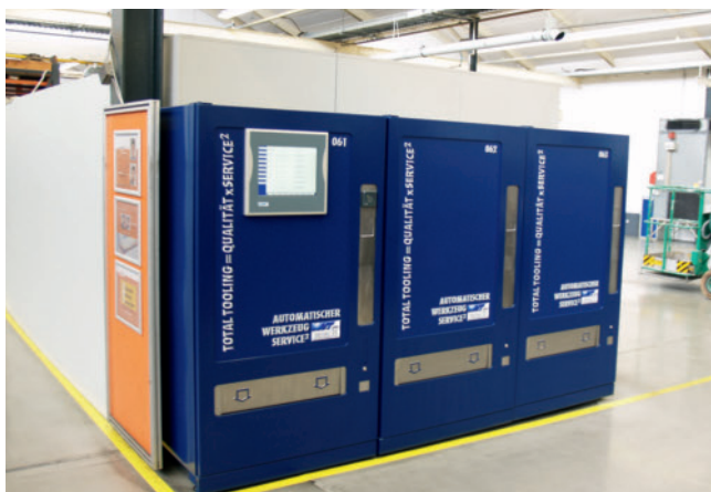
3 Die Ausgabe der Standardwerkzeuge für 22 Maschinen wird durch drei Werkzeugausgabeautomaten ›Tool-O-Mat‹ von WNT abgesichert, mit denen 180 Werkzeugtypen ständig verfügbar sind
