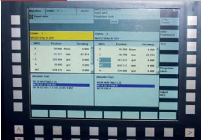
4 Anforderungsgerechter ›Split-Screen‹ für die Werkstattprogrammierung: THH ließ sich die Benutzeroberfläche an der Siemens-Steuerung der VTC 250 in zwei Bereiche teilen, um die beiden Revolver getrennt voneinander programmieren und überwachen zu können
