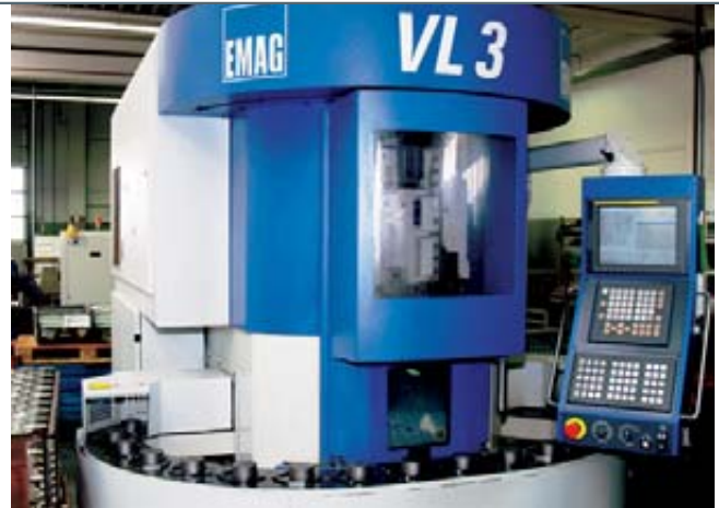
5 Rechnet sich: Mit dem Vertikal-Drehzentrum VL 3 für Futterteile bis 160 mm Durchmesser verfolgt THH sein Erfolgskonzept konsequent weiter, die Fertigung mit möglichst geringen Eingriffszeiten seitens der Mitarbeiter zu organisieren
