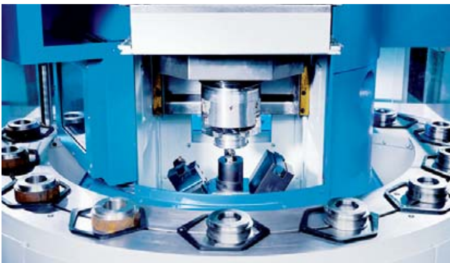
6 Die innovativen Schlepprahmen des umlaufenden Transportbandes und die flinke Pick-up-Spindel der VL 3 sorgen für kurze Rüstzeiten und schnelles Be- und Entladen
