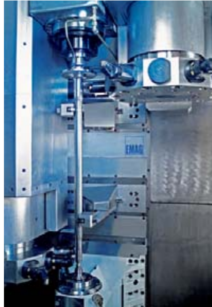
3 Arbeitsraum der VTC 250, einer Maschine fürs vierachsige Vertikaldrehen bei automatisiertem, zeitparallelem Be- und Entladen der Roh- und Fertigteile: Der Greifer in Revolver 1 entnimmt das Nachfolgeteil aus dem Rohteilsspeicher und transportiert es in Spannposition, während der Greifer in Revolver 2 das Fertigteil aus der Spannposition entnimmt und im Fertigteilsspeicher absetzt
