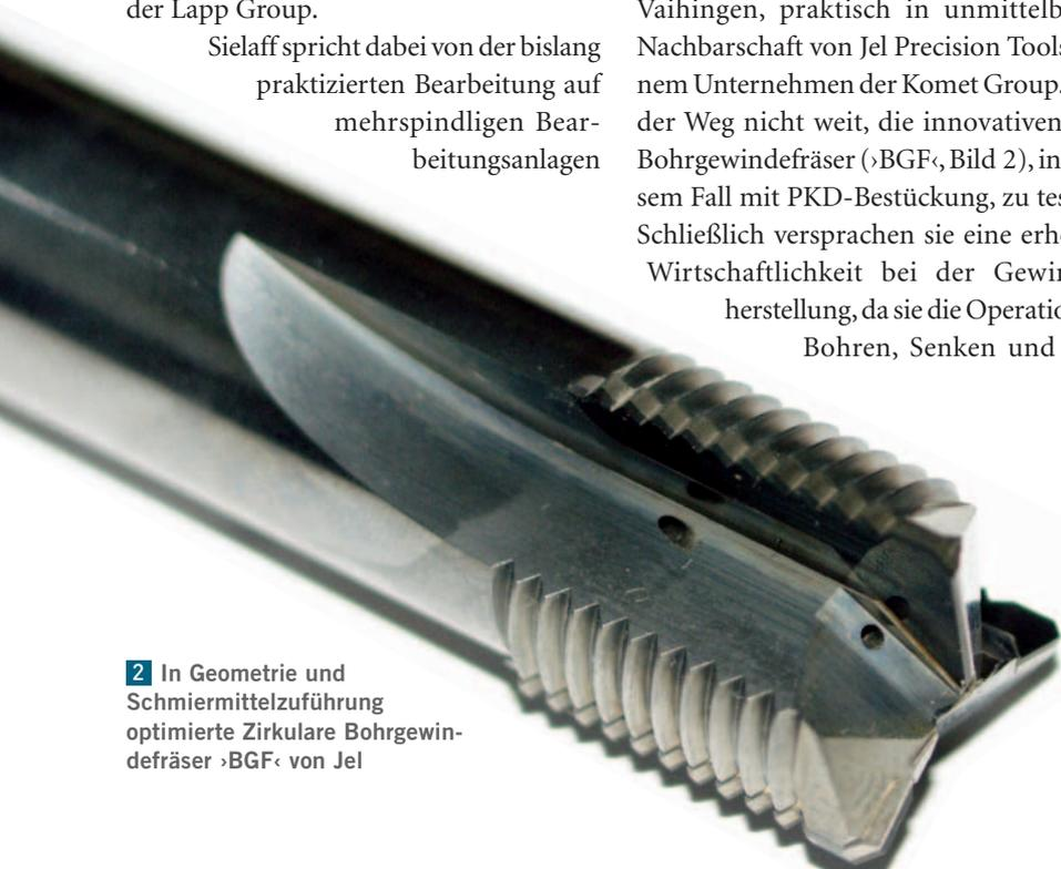
schiedene Kernloch- und Gewindedurchmesser mit gleicher Steigung hergestellt werden.
