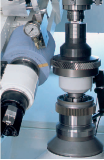
6 Im Eingriff: Das Diamant-Abricht- rad beim Konditionieren der Schleifs- schnecke im Arbeitsraum der ›245TWG‹. Das Rad ist in die Spannvorrichtung des Werkstücks integriert
