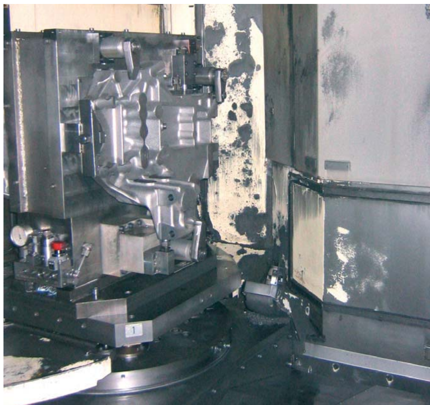
■ Harter Brocken: Der Kombinationsbock wird an der Frontseite der Werkzeugmaschine auf der Vorrichtung gespannt und mit 20 verschiedenen Werkzeugen bearbeitet
