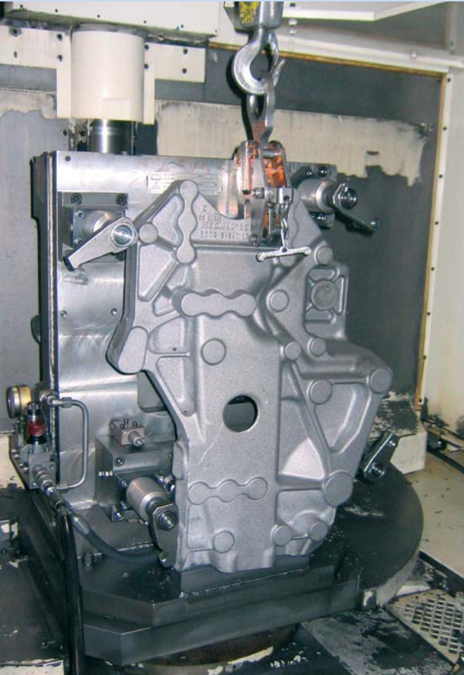
2 Saubere Sache: Durch den minimalen Eintrag an Schmierstoff bleibt der Innenraum der Maschine trocken und kann daher einfach gereinigt werden
