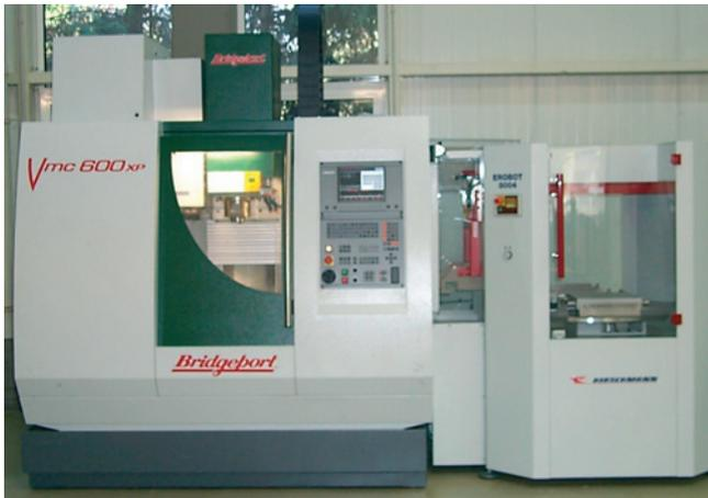
■ Automatisiertes Bearbeitungszentrum – hier die Bridgeport ›Vmc 600‹ mit Palettenwechsler ›Erobot‹ als flexible Fertigungszelle
