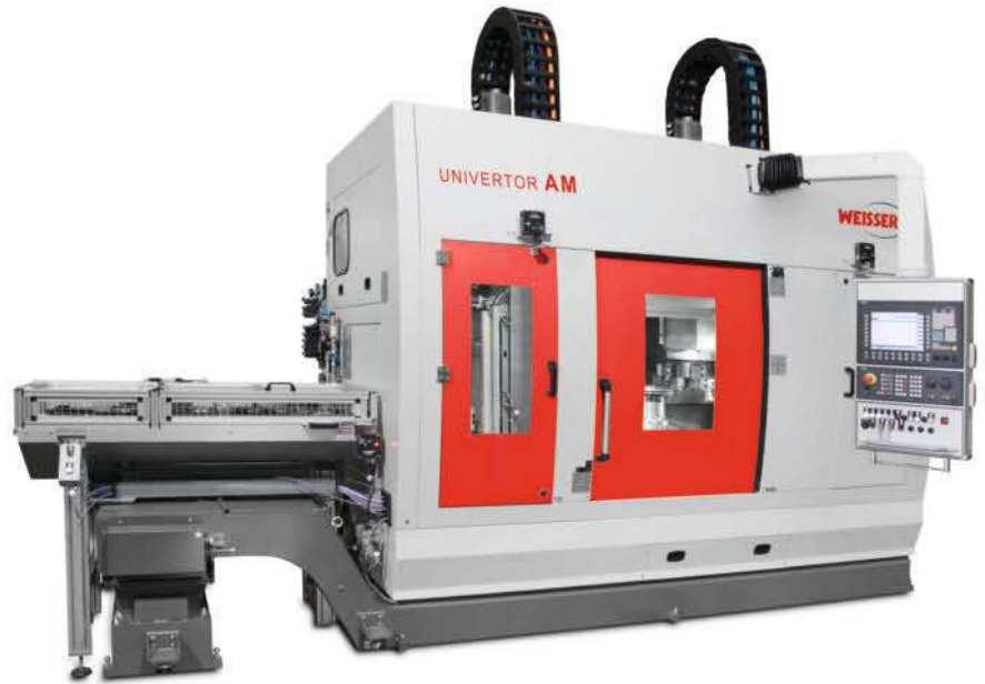
1 Univertor AM: Auf der Präzisions-Drehmaschine werden mit dem Serman-Konsol-Spannsystem Werkstücke wie Lagerringe, Zylinderlaufbüchsen, Zahnräder oder Hubkolben in einer Aufspannung deformationsfrei und präzise innen und außen bearbeitet
