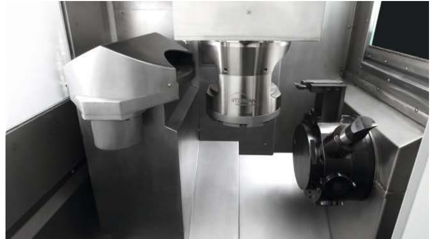
2 Blick in den Arbeitsraum der Univertor AM: Mittels Greifer wird das Rohteil in das Sterman-Spannsystem geladen. Die Konsol-Maschinenspindel führt das Werkstück in den Arbeitsraum. Dann folgt die Komplettbearbeitung
