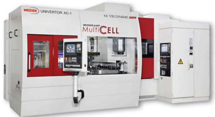
4 Die Hightech-Systemintegration Weisser-Kapp MultiCell für die Hartfeinbearbeitung von Zahnrädern in der Kombination Weisser-Rotationsdrehverfahren und Kapp-Verzahnungsschleifen
