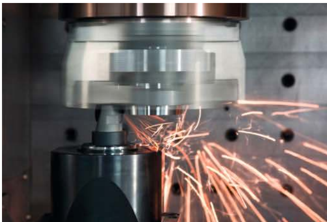
3 Rotationsdrehverfahren: generiert fein bearbeitete, drallfreie Oberflächen, ersetzt aufwendige Schleifoperationen und erzielt um bis zu 77 Prozent kürzere Bearbeitungszeiten
