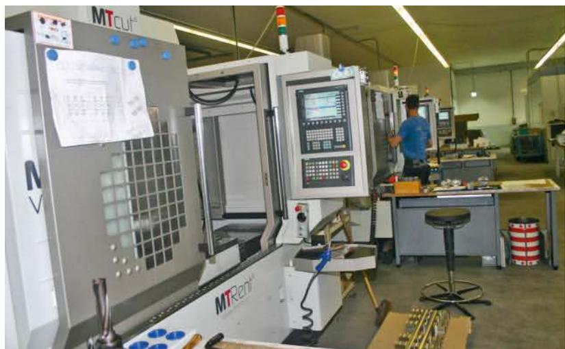
**2** Bei MBS programmiert ein Mitarbeiter mehrere Bearbeitungszentren und richtet diese ein. Wenn die Steuerung einheitlich ist, erleichtert das die Arbeit. Nicht zuletzt deshalb hat das Unternehmen seine 3-Achs-Fräsmaschinen MTCut V110 alle mit Sinumerik 828D ausgestattet
