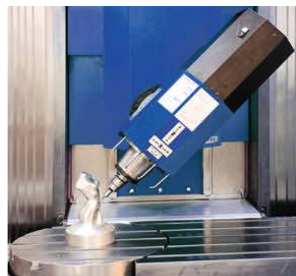
3 5-Achs-Bearbeitung optional möglich: Die blue matec-HV-Baureihe kann mit einem Rundtisch ausgestattet werden
