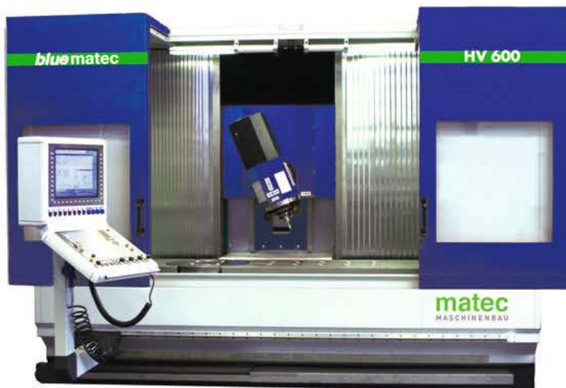
2 Fahrständermaschine blue matec HV 600: In der Version mit 2000 mm X-Verfahrgang (Y/Z = 600/800 mm) kostet die Maschine inklusive Schwenkkopf mit 1°-Hirthverzahnung ab 184 000 Euro; mit an Bord: die Heidenhain-Steuerung TNC 620
