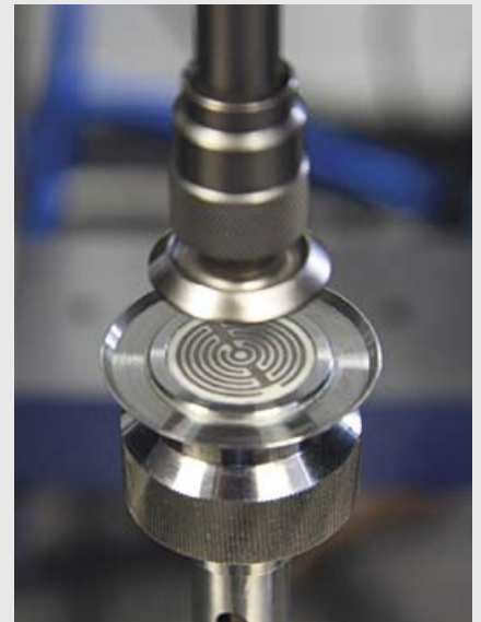
DEA 288 Epsilon mit wiederverwendbarem TMS™-Sensor (Kammsensor mit 0,5 mm Elektrodenabstand), integriert in ein MARS III Rheometer (Platte-Platte, Abstand >0,6 mm)
