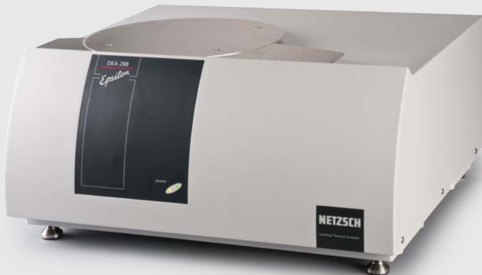
Labor-Version der DEA 288 Epsilon mit bis zu 8 Messkanälen
