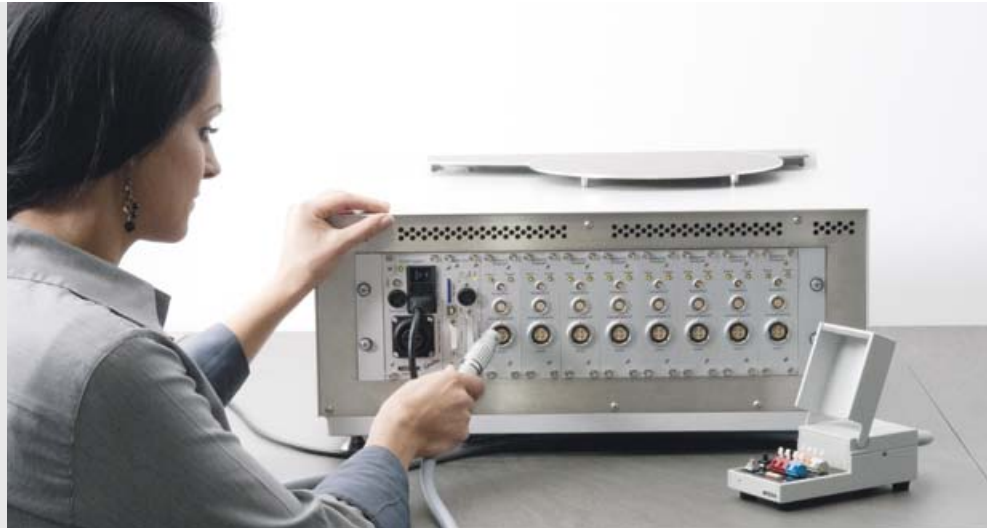
Laborversion der DEA 288 mit 8 Kanälen (Ansicht Rückseite) und Adapterbox für den Anschluss von Einweg-Sensoren
