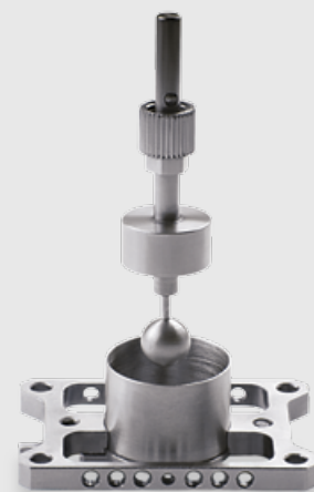
Spezieller Probenhalter mit kugelförmigem Fühlstempel für die Aushärtung niederviskoser Flüssigkeiten
