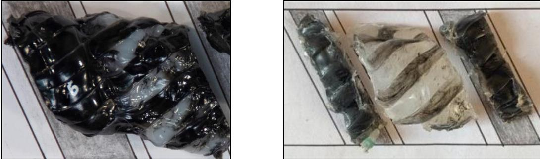
Bild 19: Draufsicht der entnommenen Versuchsproben. Links: PE-HD bei einer Drehzahl von 75 U/min und einem Werkzeuggedruck von 100 bar. Rechts: PP1 bei einer Drehzahl von 25 U/min und einem Werkzeuggedruck von 100 bar (Anhaltezeitpunkt: 1 min)
