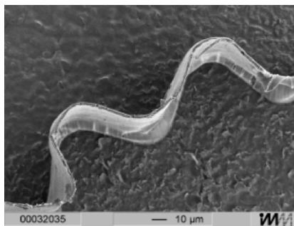
Bild 9. REM-Aufnahme einer vollständig gefüllten Kreiswand aus POM (Dicke: 2,5 µm, Höhe: 50 µm)
