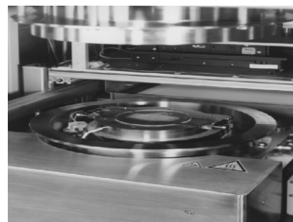
Bild 6. Geöffnetes Werkzeug einer Heißpräganlage (Foto: Jenoptik Mikrotechnik GmbH, Jena)
