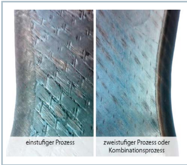
Bild 5. Auswirkung der Prozesswahl auf die Bauteiloberfläche (© Boge Rubber & Plastics)
