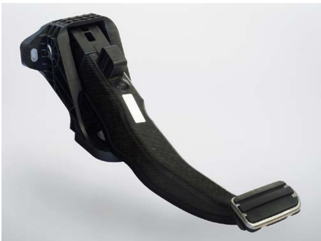
Bild 1. Das Bremspedal wiegt rund 50 % weniger als eine vergleichbare Stahlkonstruktion und erfüllt die hohen Lastanforderungen aufgrund eines multiaxialen Faserlagenaufbaus im Einleger aus Tepex dynalite (© Lanxess)
