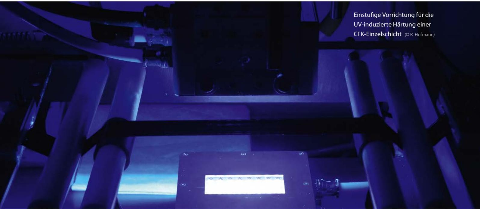
Einstufige Vorrichtung für die UV-induzierte Härtung einer CFK-Einzelschicht (© R. Hofmann)
