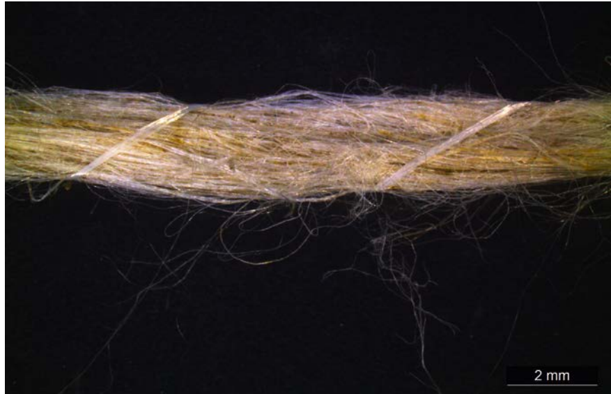
Bild 2. Umwindegarn mit parallel liegenden Flachsfasern im Kern und einem Multifilament als Umwindefaden (© ITA)
