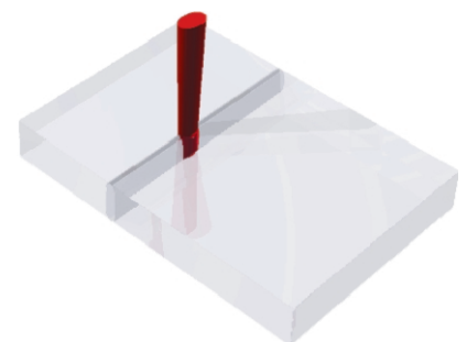
Bild 2. Schweißprinzip des 2 µ-Lasers
