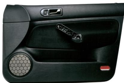
*Ein wärmebeständiges ABS erfüllt die Anforderungen an eine Türseitenverkleidung*
