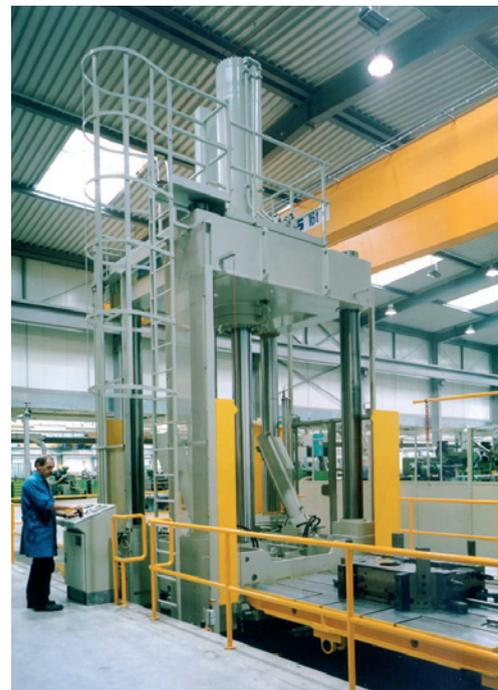
Mit einem zentralen Druckzylinder und spielarmen Mehrstoffbuchsen gewährleisten die Pressen höchste Planparallelität beim Tuschieren (Foto: Reis)
