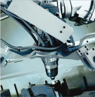
**Die TrumaForm DMD 505 in Aktion: Das Direct Metal Deposition-Verfahren schweißt Metallpulver durch Laser auf** (Foto: Trumpf)
