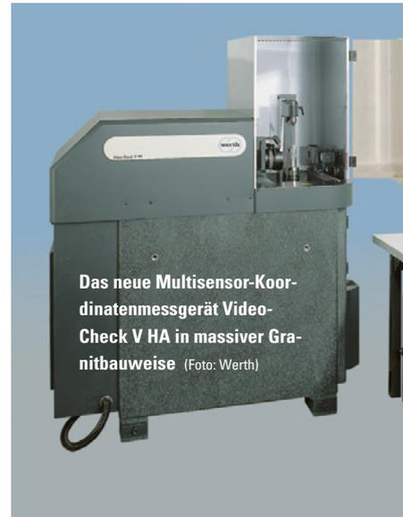
**Das neue Multisensor-Koordinatenmessgerät Video-Check V HA in massiver Granitbauweise** (Foto: Werth)
