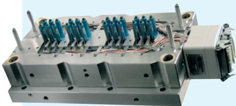
**Heiße Seite eines 24fach-Heißkanalwerkzeugs, bestückt mit den Kleindüsen N04.**
