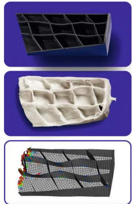
**Bild 3.** Langglasfaser-verstärkte Kunststoffe bilden während des Spritzgießens ein dreidimensionales Glasfasernetzwerk aus (Bildmitte), das dem Bauteil, z. B. einem Crash-Absorber für die Fahrzeugkarosserie, seine außergewöhnliche mechanische Leistungsfähigkeit verleiht. Auch das Verhalten solcher anspruchsvollen Bauteile lässt sich inzwischen am Computer berechnen und vorhersagen
