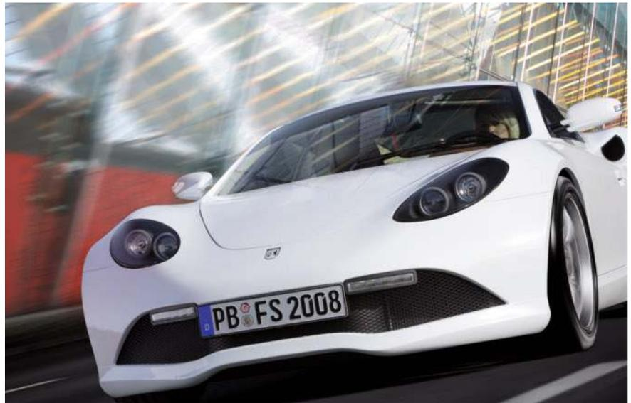
**Bild 1.** Die Karosserie des Artega GT, Kleinseriensportwagen aus Delbrück, Westfalen, besteht überwiegend aus Polyurethan, das mit kurzen Mineral- und Kohlenstofffasern verstärkt ist
