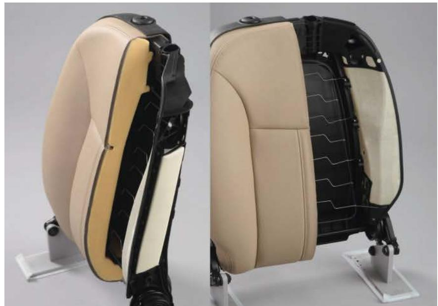
**Bild 6. Der Prototypensitz SUSCO 1.5 von Faurecia, zusammen mit BASF entwickelt, nutzt in der Sitzlehne thermoplastische Endlosfasertapes (im Bild weiß), die in einem zweiten Schritt mit einem Spezialpolyamid (schwarzes Sitzlehnenteil) umspritzt werden. Der Ersatz der bestehenden Metallstruktur in der Sitzlehne durch die einteilige Kunststoffkomponente verringert das Gewicht der Lehne um etwa 20 %**
