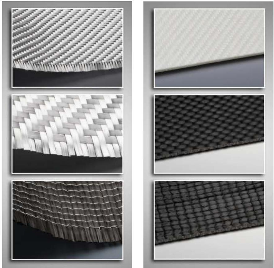
**Bild 9. Unterschiedliche Glas- und Kohlenstofffaser-Textilstrukturen auf Basis von Geweben und Gelegen (links); unterschiedliche RTM-Faserverbundlaminate auf Basis von Polyamid, Polyurethan und Epoxidharz (rechts)**
