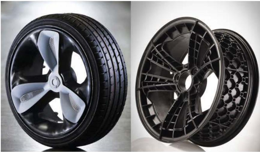
**Bild 2.** Das auf der IAA 2011 vorgestellte neue Konzeptfahrzeug smart forvision verfügt über die weltweit erste thermoplastische Kunststofffelge mit Potenzial für die Großserie. Das Bauteil aus langglasfaser-verstärktem Polyamid ist mit 6 kg Gewicht etwa 30 % leichter als eine serienmäßige Aluminiumfelge und reduziert das Gesamtgewicht des Fahrzeugs um 12 kg
