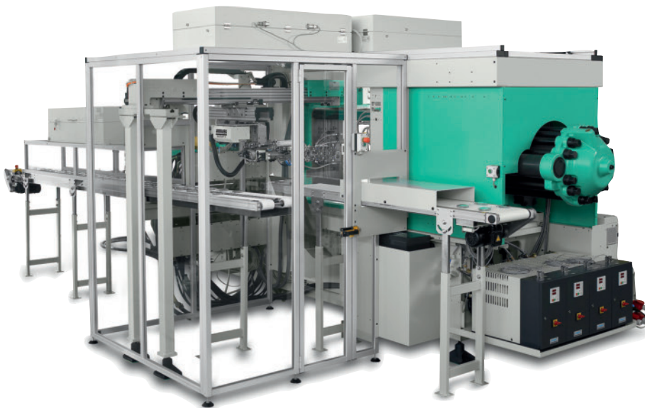
Bild 5. In der Fertigungszelle für die Produktion ophthalmischer Linsen sind Flowboxen integriert
