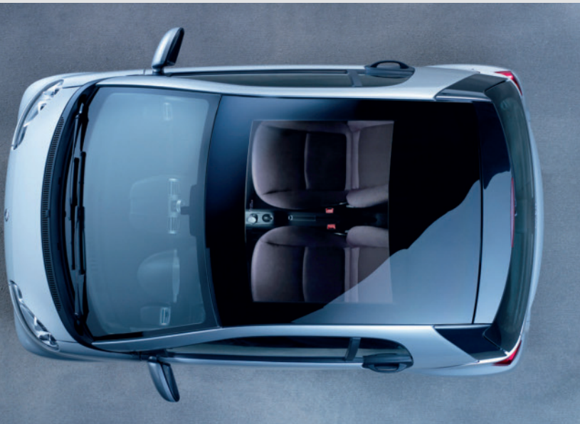
Bild 4. Smart-Dach: Der aktuelle Smart verfügt über ein Panoramadach aus Polycarbonat
