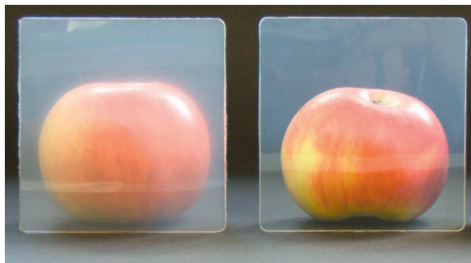
Bild 2. Vergleich von nukleiertem (rechts) und nicht-nukleiertem (links) Polypropylen (Foto: Ciba)
