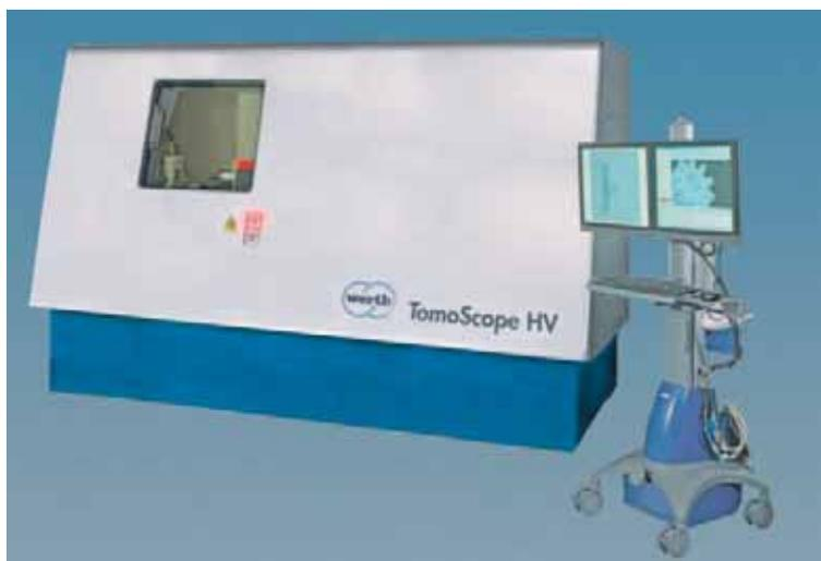
**Die neue Geräteversion misst und digitalisiert bis zu 40 kg schwere Werkstücke mit Computertomografie**
