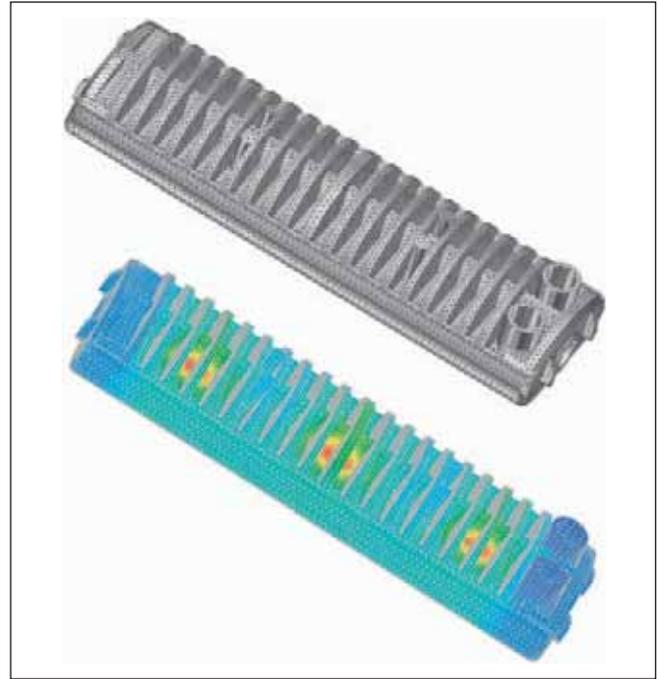
**Bild 4. Die Lage der beiden seitlichen Anspritzpunkte wurde so gewählt, dass sich die Kavität im Bereich der Grundplatte des Kühlkörpers schnell füllt, während die Kühlrippen selbst zunächst noch ungefüllt bleiben**
