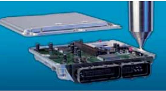
**Bild 3.** Die Vorbehandlung und Aktivierung der Gehäusefügeflächen – vor dem Aufbringen des Klebstoffs – mit Openair-Plasma bewirkt eine optimale Dichtigkeit der Elektronikverpackung
