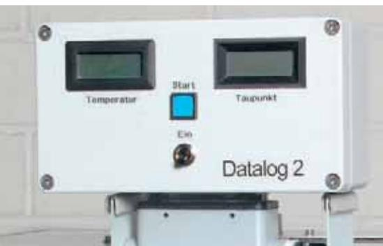
Bild 2. Digitale Kontrolleinheit
