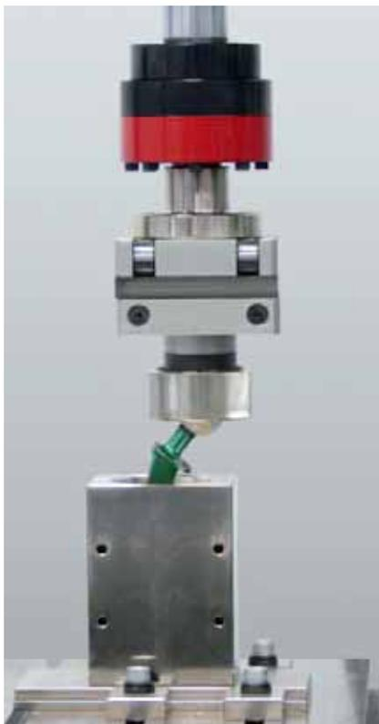
vorgegebenen Winkel nach ISO 7206-4 wurde eine Einbettvorrichtung mit Winkelbestimmung konstruiert, die korrektes Einbetten ermöglicht und damit Reproduzierbarkeit der Ergebnisse sicherstellt. Durch den modularen Aufbau des gesamten Prüfsystems lassen sich auch weitere Aufnahmen für Hüftprothesen mit anderen Geometrien und Fixationsarten verwenden.
