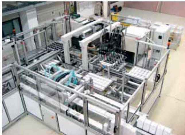
**Automation einer Fertigungszelle für Pipettenspitzen**
