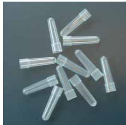
**Verbrauchsmaterial wie Pipettenspitzen (Tips) und kleine Kunststoffbehälter (Cups), die z. B. Blutproben für Analysegeräte aufnehmen, zählen zur Produktgruppe der sogenannten Disposables**
