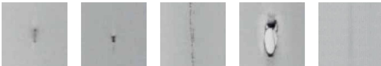
**Bild 2. Bilder von Foliendefekten (v.l.n.r.: Stippe, schwarzer Punkt, Struktur, Loch, Verbrennung)**
