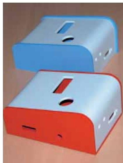
Die neue Biegetechnik ermöglicht nahezu perfekte Rundungen, z. B. an Kunststoffgehäusen
