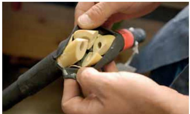
Die Mitarbeiter der Argo konfektionieren die künstlichen Brüche an den Polyurethan-Knochen sorgfältig mit Werkzeugen wie einer Säge oder auch Hammer und Meißel (links). An solchen Frakturbeispielen üben Anfänger, Bohrlöcher oder Implantate richtig zu setzen (rechts)
