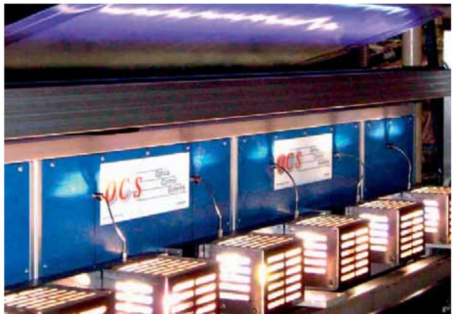
Bild 10. Beleuchtungskonzepte zur Detektion von optischen Foliendefekten
