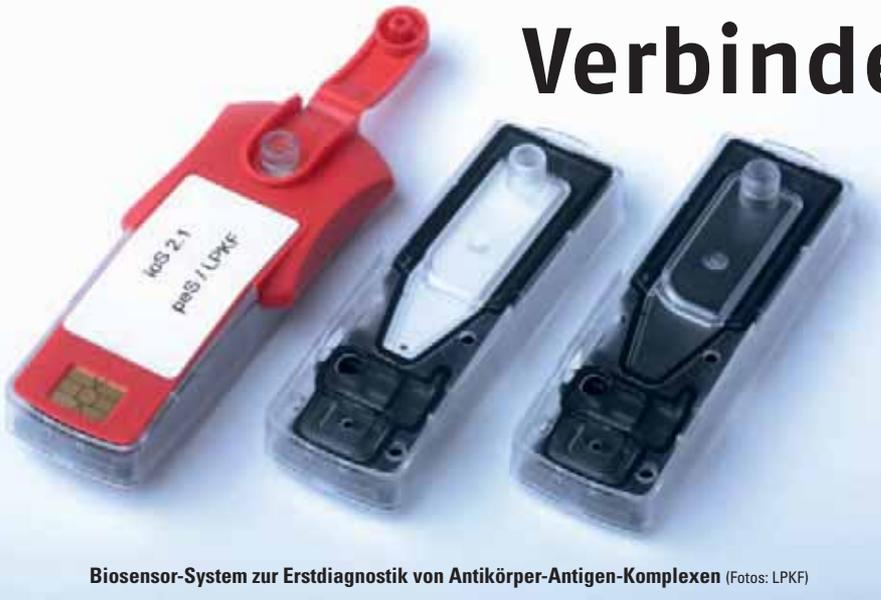
Biosensor-System zur Erstdiagnostik von Antikörper-Antigen-Komplexen (Fotos: LPKF)
