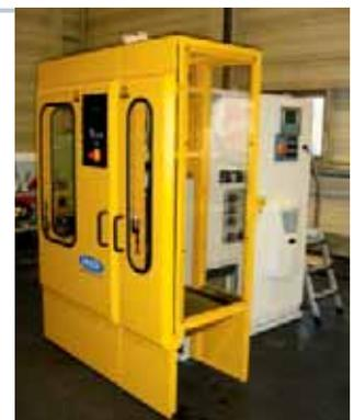
Die HK200 kann mit Zusatzeinrichtungen und Optionen zur Reinraumtechnik wie z.B. Edelstahl-Bauteilen oder Blasluftfiltern ausgestattet werden (Foto: Hesta)
