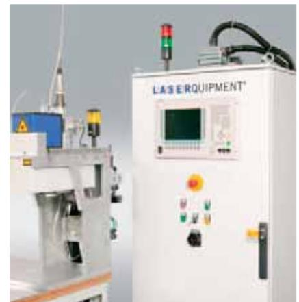
**Bild 1.** LQ-Integration-Schweißsystem bestehend aus einem kompakten Schweißkopf und einem separaten Schaltschrank
