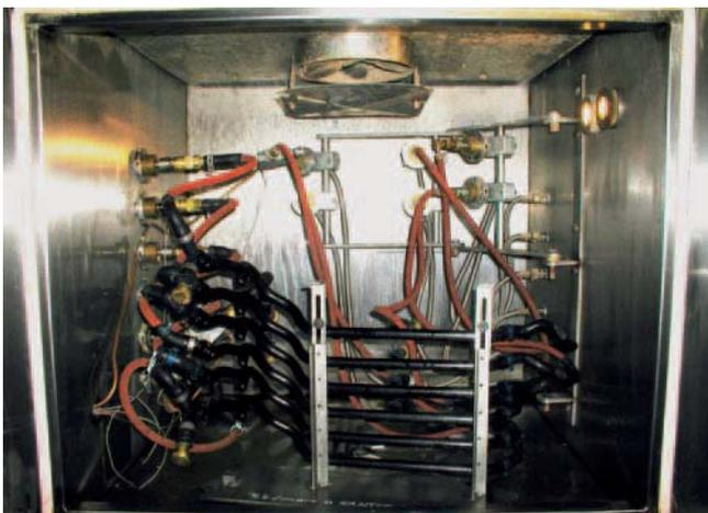
**Bild 1. In einem Alterungstest wird die zu erwartende Produktlebensdauer der mit der PIT hergestellten Bauteile ermittelt**
