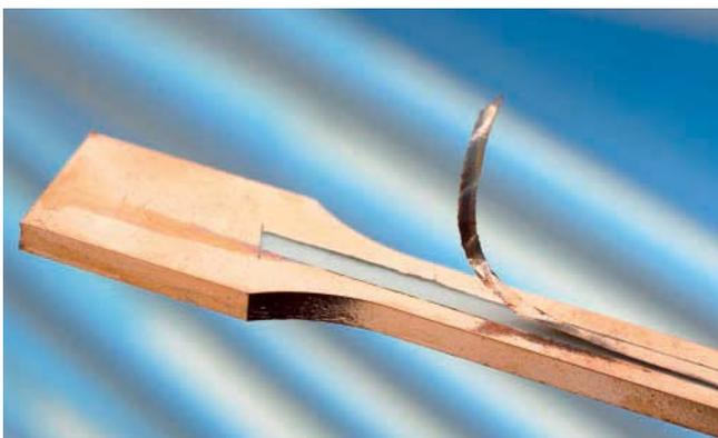
**Bild 7. Metallisierter Zugstab nach dem Schälversuch nach DIN 53494**
