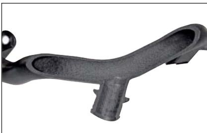
**Bild 6. Das Projektill-Verfahren erzeugt eine homogen strukturierte Innenoberfläche**
