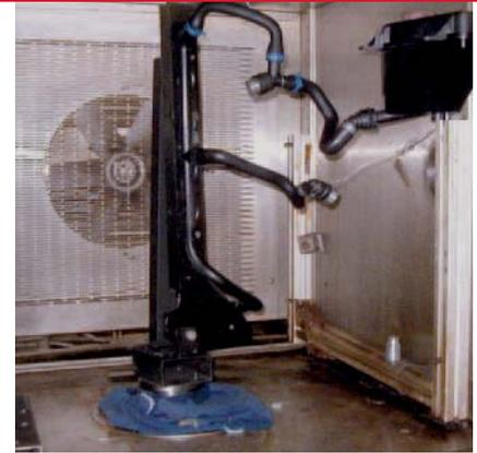
**Bild 5. Rütteltest im Shaker-Ofen für alle fahrerbetriebstypischen Frequenzen und Temperaturen**
