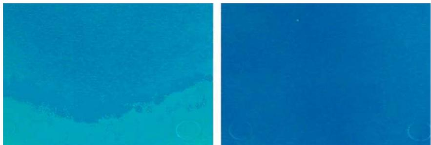
**Bild 6. Einfärben von PBT: Die Pigmente werden bei Verwendung von Ultradur High Speed deutlich gleichmäßiger dispergiert und führen zu einer besseren Farbverteilung (links: 0,1 % blaues Farbbatch (Eupolen) in Standard-PBT, rechts: in Ultradur High Speed)**
