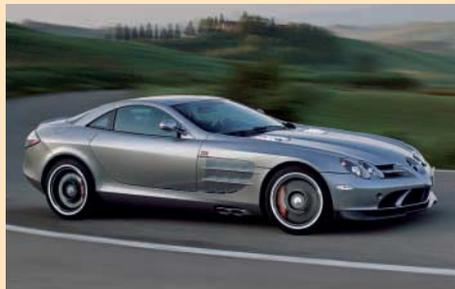
**Bild 1. Karosserie und verschiedene Konstruktionselemente des Supersportwagens Mercedes-Benz SLR McLaren 722 bestehen aus Kohlefaser-Verbundkunststoffen**
