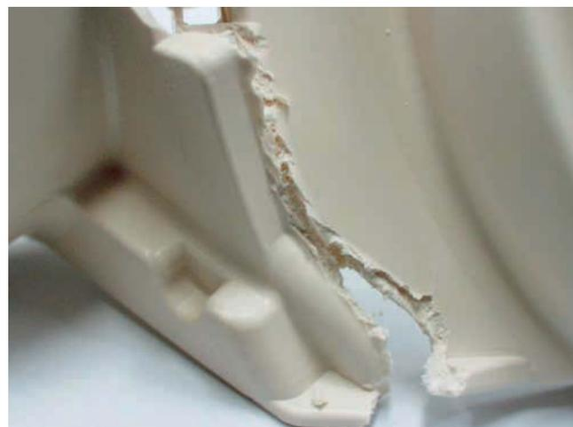
Bild 1. Zu hoher Anteil an Glasfasern: Sprödebruch eines glasfaserverstärkten BMC-Bauteils
