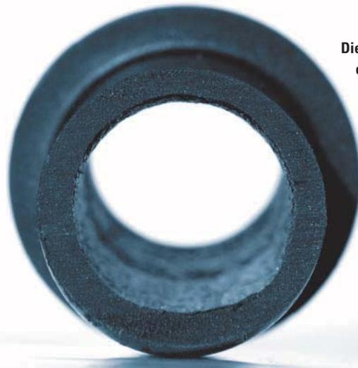
Die Teile zeichnen sich durch einen über die gesamte Bauteillänge gleich bleibenden Innendurchmesser bei minimaler Wanddicke aus
