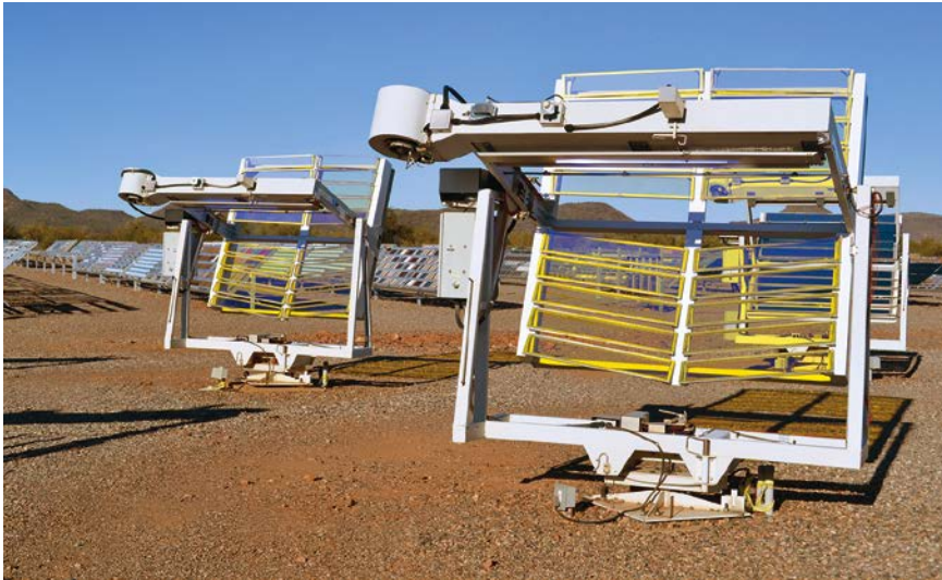
Bild 8. UA-EMMA-Prüfstand (Ultra-Accelerated Equatorial Mount with Mirrors for Acceleration) zur Durchführung beschleunigter Freibewitterungsversuche (Bild: Atlas Material Testing Technology)
