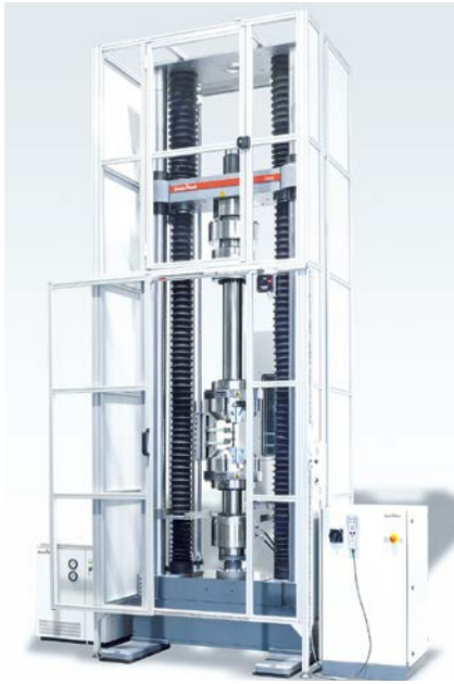
Bild 4. Modulares Prüfsystem für Faserverbundwerkstoffe. Die Maschine ermöglicht mechanische Tests an größeren Proben mit Prüfkräften von bis zu 600 kN in einem Temperaturbereich zwischen -55 °C und 350 °C gemäß allgemeinen Normvorgaben oder firmeneigenen Regelwerken von Airbus oder Boeing (Bild: Zwick)
