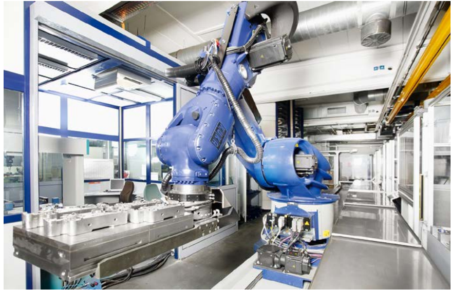
In der voll automatisierten Erodierfertigungslinie spielen Robotik und Transpondertechnik zusammen (Bild: Hofmann)
