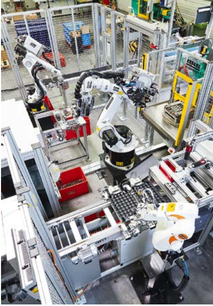
Bild 6. Synchronisiertes Trio: Ein Sechssachsroboter führt Metalleinleger lagerichtig zu, der zweite übernimmt Einleger und Kontakte und bestückt das Werkzeug und der dritte ist für die Kameraprüfung der Fertigteile zuständig
