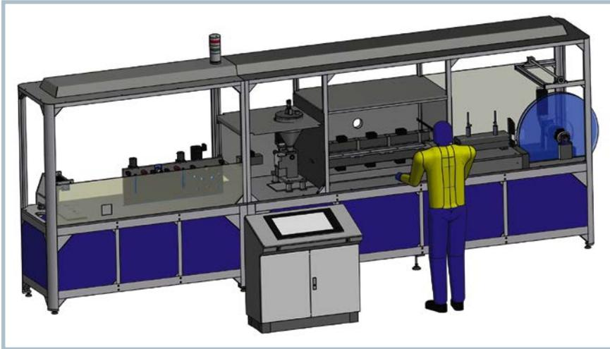
**Bild 1.** Die Produktionsanlage, mit der ein Roving in gleichbleibender Qualität gespreizt und mit Pulverbinder imprägniert wird. Dadurch entsteht das textile und stabilisierte UD-Faserband „fixedTow“ (© M&A Dieterle)
