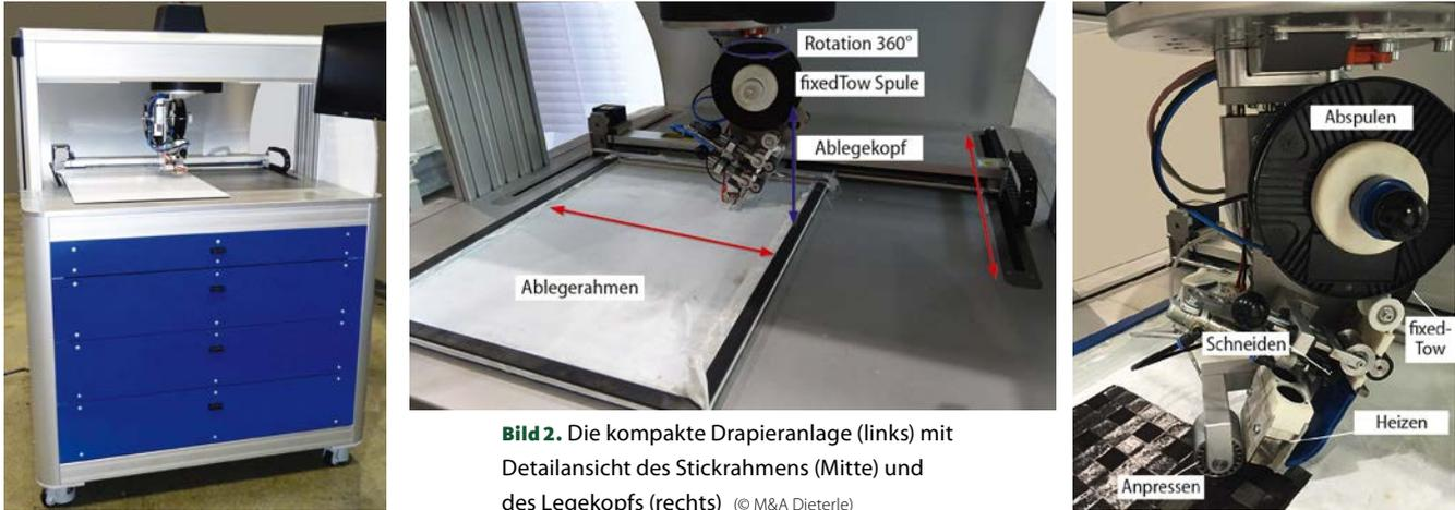
**Bild 2.** Die kompakte Drapieranlage (links) mit Detailansicht des Stickrahmens (Mitte) und des Legekopfs (rechts) © M&A Dieterle)
